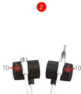
Säädä vesi arvoon 10 Kytke laitteeseen virta (ON)
